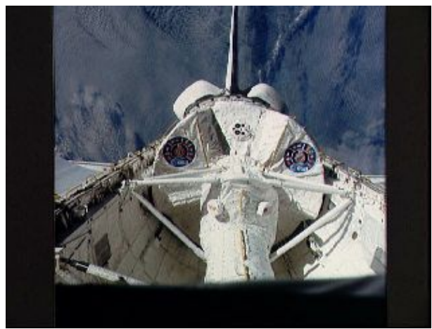
Figura 3: El Spacelab en la bodega de carga del Columbia durante la STS 9. El túnel blanco en primer plano es el pasadizo entre el laboratorio y la cabina de vuelo.
